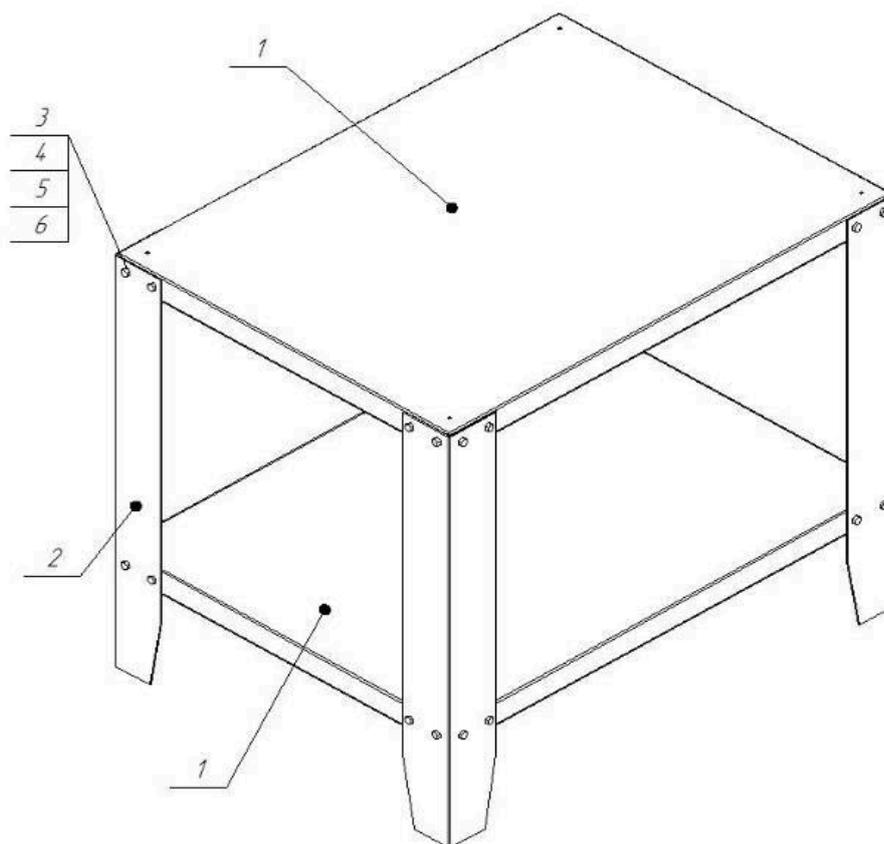
1– полка, 2 – ножка с регулируемой опорой, 3 – болт , 4 – гайка , 5 – шайба-гровер, 6 – шайба. Подставка поставляется в разобранном виде.
